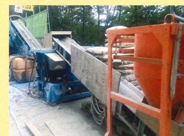
仮設吹付プラント コンクリート吹付から緑化吹付まで施工できます。
