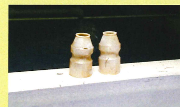
浄化用ヤクルトろ材 ヤクルト容器の底を切ったものを使用。生物膜ができています。
